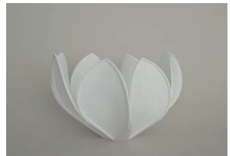
写真右：熱湯をかけると不織布が収縮して、美しい蓮の花のように周囲が立ち上がる。この理論を応用して、建築に活かせないか、というのが亮平氏の研究。大学院修了時の制作からスタートし、2017年に教育研究助手として金田研究室に戻り、3年前に研究費を受領、研究を継続している
