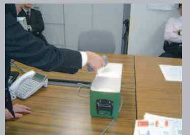
暖めた鉄板の塗布面の温度を計測。200°以上の高熱を感じさせない。
