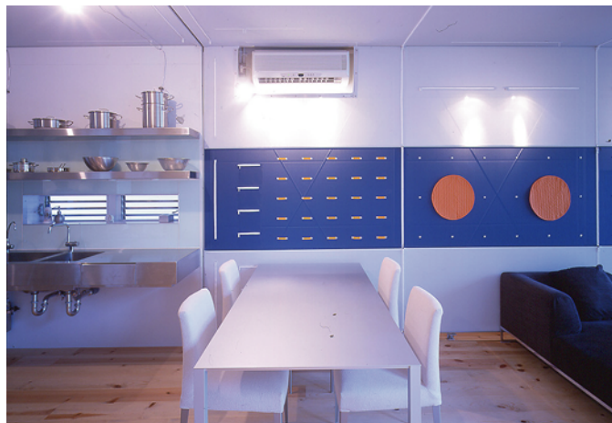
「inner skin house」のリビングルーム。ガラス繊維とPVC平織りを組み合わせた膜材を内装材として採用、ジッパーでつなぎ合わせて斬新なインテリアを試みている。
