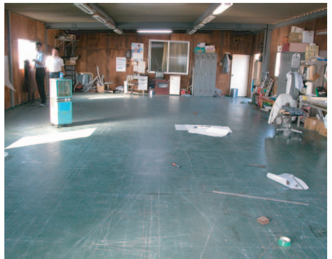
原寸場:図面を原寸で床に起こし、鉄骨や鉄板をここで加工する。設計事務所は、最終的にここで「原寸検査」を行う。この日も、床に様々な図形が描かれていた。
