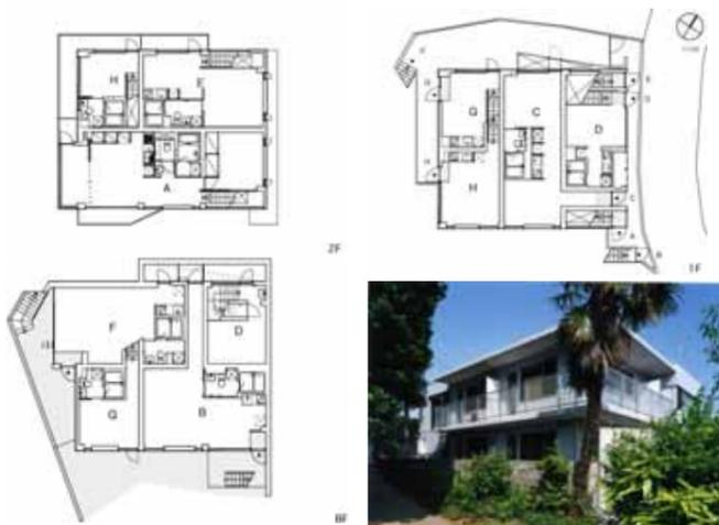
「m-house(レントハウス茂手木)」Plan。北面全景。隣地の豊富な緑が大きな開口部を通して室内から楽しめる。東面全景。通行人の視線を遮るため、目線の合う2階の窓は小さめに。1階中央に全ての住戸のメーターボックスを集めた。ガルバリウム鋼板の外断熱を施している。西側夜景 G-1F。左の階段を下りると、個室とバスルーム。地階から裏庭に出られる。地階F-typeへの階段。植栽の雰囲気と打ち放しの開放感が面白い。地階B-typeのエンタランス。1階の半分を吹き抜けのようにダイナミックに利用している。(撮影:齋部功)
