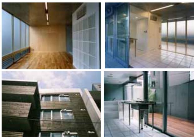
全景：3つのユニットは、A棟とB棟の間はエレベーター、B棟とC棟の間は階段になっている。コンクリート打ち放しだが、ペントハウス部分には、ガルバリウム鋼板の外断熱を行っている。賃貸402号室のフローリング部分。右側の白い置家具の裏はキッチンと設備、右手奥にトイレ・バスルームがある。401号室の濡れ縁部分。手前のバルコニーとの間、奥のフローリングとの間にガラス引戸が設けられており、それぞれ、収納されるようになっている。バルコニーのないB棟と左側のエレベーターホール側のルーバー。103号のデッキガーデンと白いタイルの濡れ縁部分。ミニマルなキッチンの向こう側がバスルーム (撮影： 齋部功、編集部)
