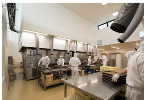
高い天井、脱気ダクトが熱と匂いを逃す3階の焼物室
