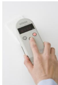
トライボギアシリーズ「ポータブル摩擦計ミュース」は室内だけでなく屋外でも測定可能。床面や生産ライン上の各部摩擦、紙、繊維、プラスチック、木材など対象物を選ばない。
