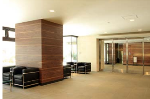
ロビー、天井照明取替え、壁は石に貼替え、床タイル貼替え、新たにソファセットを置き、居住者がよりくつろいでコミュニケーションをとれる空間に
