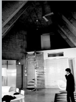
外壁に汚れやクラックが出ており、地下への階段室で大雨の時に内部に雨がしみていた。4 階フリースペースは最高天井高 6 m 以上の大空間。ロフトへの階段はアーティスティックなデザインの輸入品。ガラスブロック裏の洗面所には簡単なシャワー設備があり、コンクリート打ち放しの内部は断熱がなく、床はモルタル仕上げだった。
